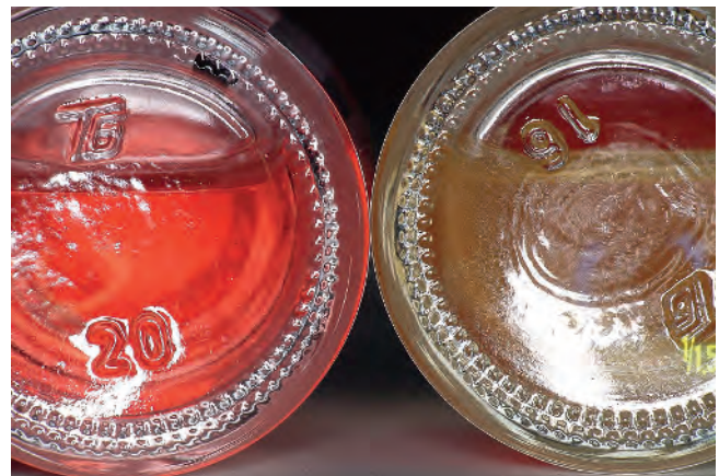
Abb. 4 Bei einem Absinken des pH-Wertes unter 6 verfärbt sich das rosa Medium (links) gelb (rechts)
